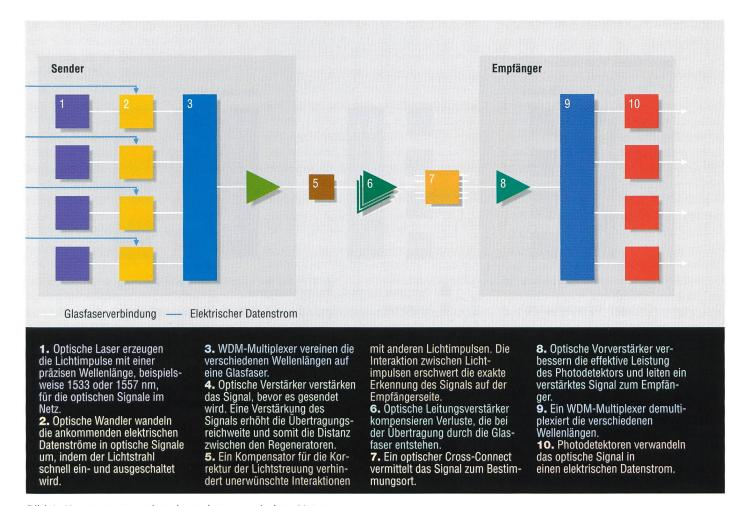
Bild 1. Komponenten eines kompletten optischen Netzes.
