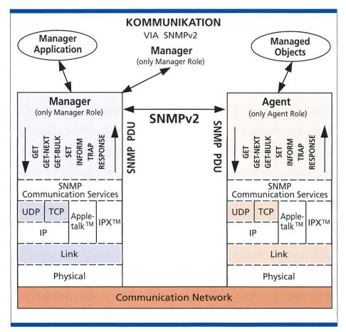
Bild 15. Kommunikation zwischen Manager und Agent via SNMPv2.
