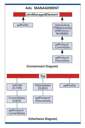
Bild 8. AAL Management (Erweiterung der M4-Netzelementsicht).
