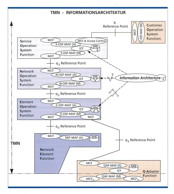
Bild 3. TMN-Informationsarchitektur mit detaillierter Informationsbeschreibung (Definition der «Managed Objects», MIB, ICF).
