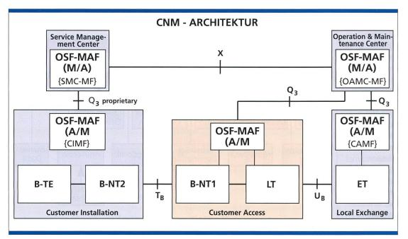
■ Bild 10. CNM-Architektur für den ATM-Kundenzugriff (basierend auf ITU-T 1.610). TMN-Begriffe aus ITU-T M.3010. OSF: Operation System Function, MAF: Management Application Function, M: Manager, A: Agent, CNM: Customer Network Management. TMN-Begriffe aus ITU-T I.610. SMC-MF: Service Management Center Management Function, CIMF: Customer Installation Management Function, OAMC-MF: Operation And Maintenance Center Management Function, CAMF: Customer Access Management Function.
