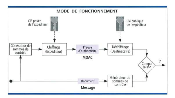
Fig. 1. Mode de fonctionnement des signatures électroniques.
