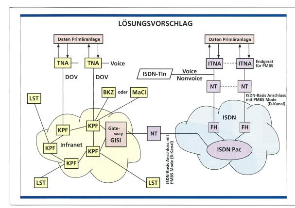
Bild 1. Lösungsvorschlag mit GISI. Kompatibel zu TNA30 bezüglich Schnittstellen.
