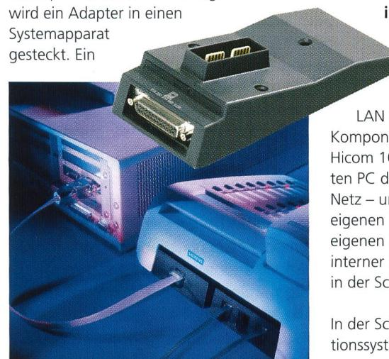
handelsübliches Kabel stellt die Verbindung her – schon ist das Telekommunikationssystem um einen Apparat erweitert. Auch hier hat der Hicom 100 E in der neuen Version noch einmal gewaltig zugelegt. Mit einem ganzen Sortiment von Adapters können nun Systemapparate, analoge Geräte, Kopfhörer, Mikrofone und sogar der PC angeschlossen werden.
