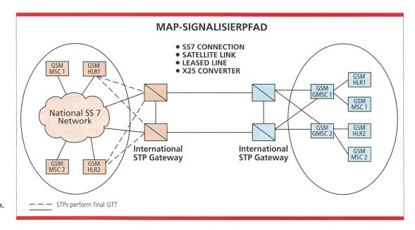
Bild 1. Schematische Darstellung des MAP-Signalisierpfads.
