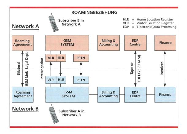
Bild 2. Aufstellung des Ablaufs zur Realisierung einer Roaming-Beziehung.
