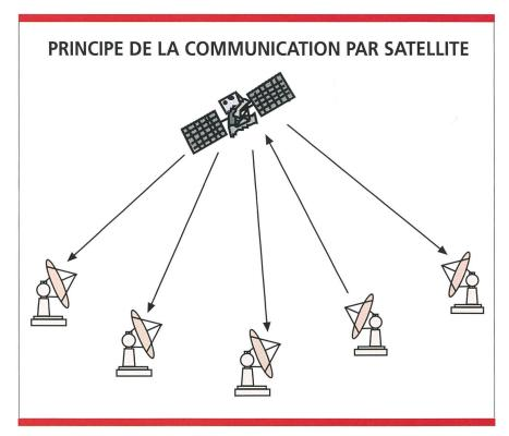
Fig. 1. Le satellite est prédestiné à distribuer un signal provenant d'une station terrienne à plusieurs autres.
