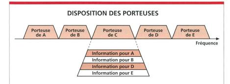
Disposition possible des porteuses dans un système AMRF. Une porteuse contient les informations destinées à toutes les stations partenaires de sa station émettrice. La figure représente la porteuse émise par la station terrienne C. Les diverses informations sont entrelacées dans la porteuse selon un principe de multiplexage dans le temps.
