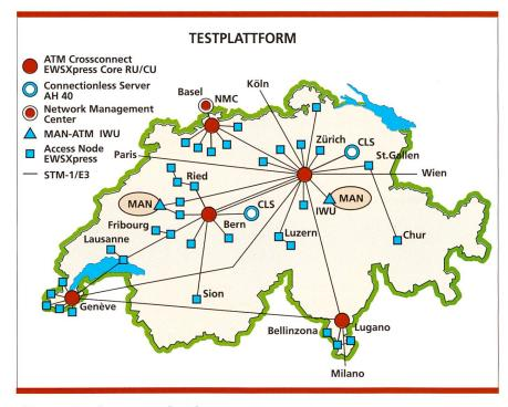
Bild 2. Das aktuelle ATM-Netz der Telecom PTT.
