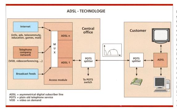
Bild 2. ADSL-Technologie über Kupferleitungen im Anschlussbereich (Amati Communications Corp.). Mit ADSL werden Sprache und Daten gleichzeitig und unabhängig über die existierende Anschlussleitung gesandt. Im Gegensatz zum ISDN. welches Sprache und Daten in digitaler Form überträgt und demnach mit analogen Telefonapparaten grundsätzlich nicht kompatibel ist, wird der analoge Telefondienst hier in traditioneller Art übertragen (Filter).
