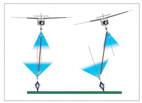
Bild 2. Signalübertragungen via Richtfunk erfordern freie elektrische Sicht. Der Öffnungswinkel der Sende- und Empfangsantenne muss so gewählt werden, dass eine grössere relative Verschiebung zwischen Kameramotorrad und Relaisflugzeug ohne Signalverlust möglich ist.
