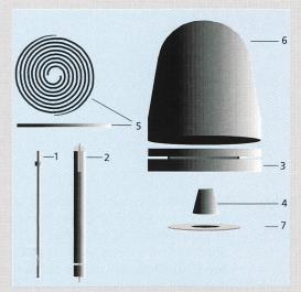
Bild 12. Aufbau der Antenne. 1: Innenleiter, 2: Aussenleiter mit Schlitzübertrager, 3: Reflektor, 4: Spannzange, 5: Spiralscheibe, 6: Radom, 7: Scheibe
