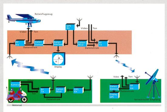
Bild 9. Die Kameramotorräder, der Kamerahelikopter sowie das Relaisflugzeug sind mit je einem GPS-Empfänger ausgerüstet.
