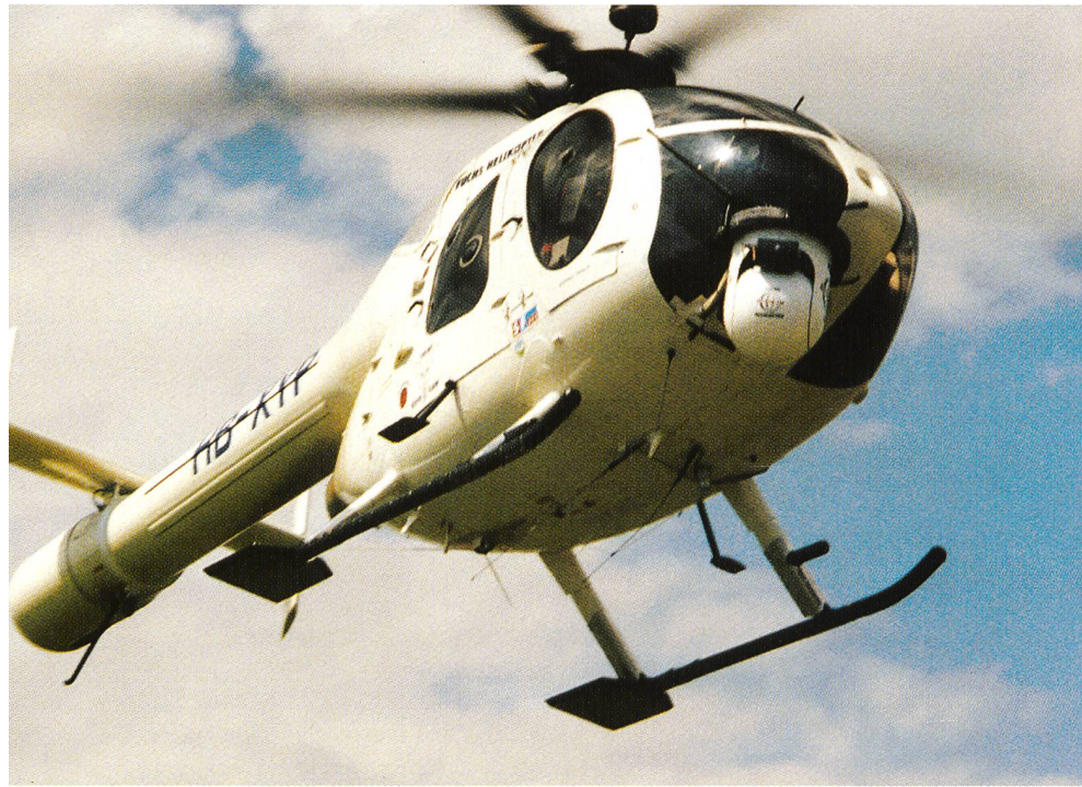
Bild 5. Um einen Überblick über das Renngeschehen vermitteln zu können, wird zusätzlich ein Kamerahelikopter eingesetzt. Die Kamera ist aus dem Cockpit steuerbar. Zentral über dem Rotor befindet sich die Sendeantenne (Bild 6).
