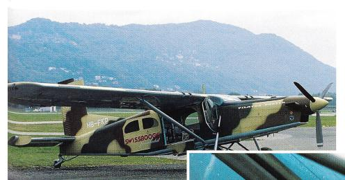
Bild 7. Das Flächenflugzeug dient als mobile Relaisstation, empfängt die Bild- und Tonsignale der Kameramotorräder und des Kamerahelikopters und gibt sie weiter an die terrestrische Empfangsstelle. Aus dem geöffneten Flugzeugboden sind die Sende- und Empfangsantenne sowie die Funkantennen sichtbar.
