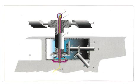
Bild 6. Konstruktionsprinzip der durch die drehbare Rotorwelle geführten fixen Antennenbefestigung bzw. Signalzuführung. 1: Antenne, 2: Antennenhalterung, 3: Getriebebox, 4: Turbinenwelle, 5: Heckrotorwelle, 6: Hauptrotorwelle, 7: Hauptrotorblätter, 8: Helikopterrumpf, 9: Antennenkabel.
