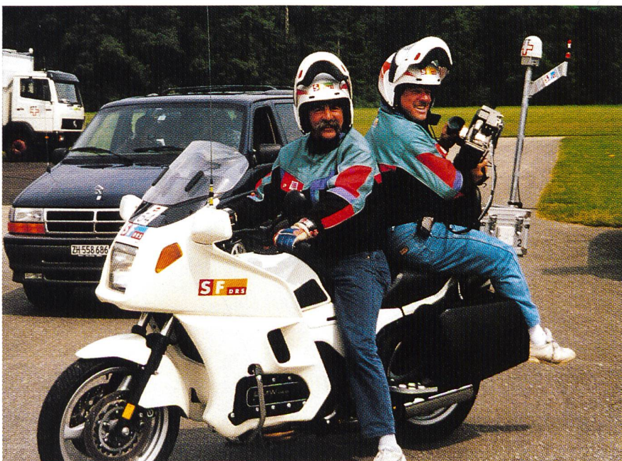
Bild 4. Das Kameramotorrad ist mit einem Richtfunksender bestückt, der zusammen mit den Stromversorgungsbatterien in den Sacothen untergebracht ist. Die Sendeantenne ist auf dem überhöhten Stabende befestigt.
