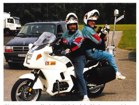
Bild 4. Das Kameramotorrad ist mit einem Richtfunksender bestückt, der zusammen mit den Stromversorgungsbatterien in den Sacochen untergebracht ist. Die Sendeantenne ist auf dem überhöhten Stabende befestigt.
