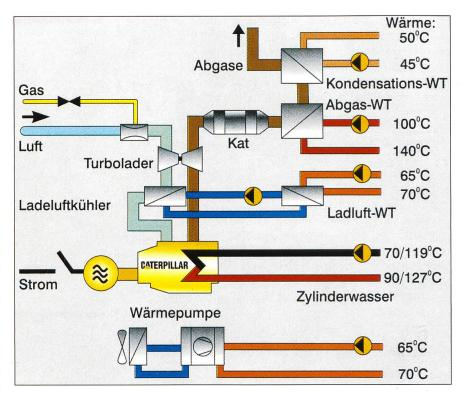
Bild 5. Energieflussdiagramm.
