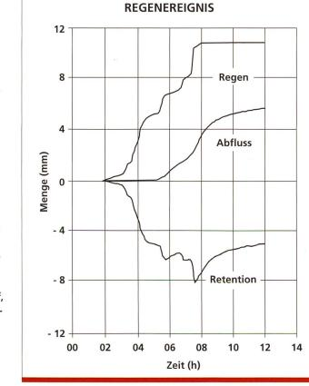
Bild 4. Grafische **Darstellung eines** Regenereignisses mit Regen- und Abflusskurve sowie Retentionsverlauf von Mitternacht bis Mittag. Die Retention weist vor 8.00 Uhr einen Knick auf, was auf einen Rückstau des Wassers, bedingt durch die Schlitzöffnungen der Rückhalteringe, hinweist.
