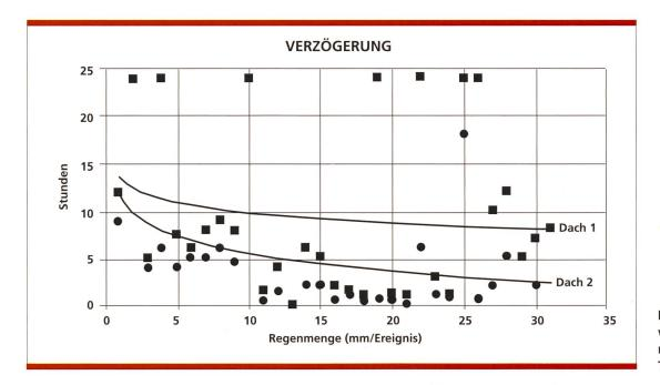
Bild 10. Verzögerung von Dach 1 und 2, mit logarithmischer Trendlinie.
