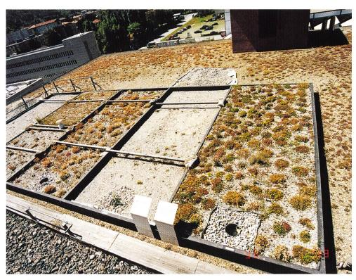
Bild 1. Übersicht über die fünf Versuchsflächen (rechts Dach 1, ganz links Dach 5) mit unterschiedlichem Pflanzenwachstum. Die Dächer 2 und 5 weisen keine Wasserspeicherplatte auf.
