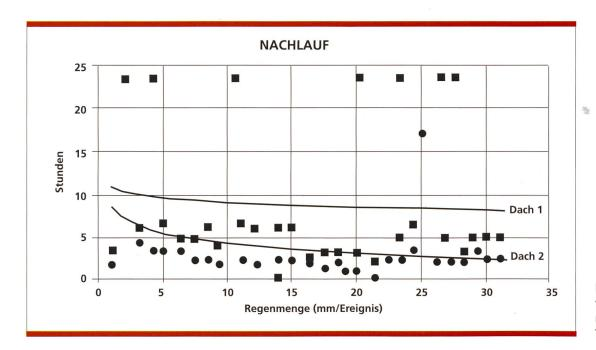
Bild 11. Nachlauf von Dach 1 und 2, mit logarithmischer Trendlinie.
