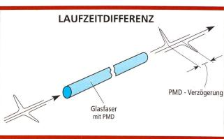
Sie beeinflusst die maximale Übertragungsrate bei digitalen Systemen. Wir werden später noch sehen, dass auch analoge Systeme (z. B. CATV) beeinflusst werden.
