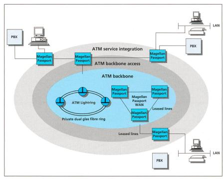
Abb. 2: Schematische Darstellung der Ebenen für Dienstintegration, ATM-Zugang und ATM-Transportnetz (hier als vermaschtes WAN mit Passport-Knoten oder als Ring-Configuration mit ATMLightRing®-Knoten angedeutet).
