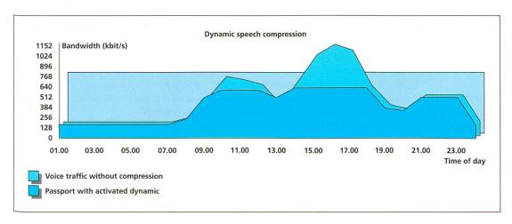
Abb. 3 B: Dynamische Sprachkompression bei Annäherung an die Grenze der Transportkapazität.
