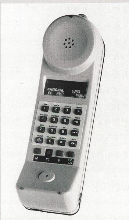
Messmöglichkeiten ist es dem Telefon spezialist jederzeit möglich, sämtliche Anschlüsse, welche er im Einsatz antrifft, auf ihre Funktionalität zu überprüfen, ohne dass er speziell den Einsatz seiner Messgeräte planen muss.
