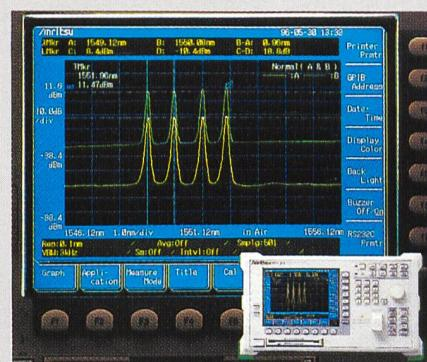
Fülle von Anwendungen im Bereich R&D, Produktion, Installation und Wartung. Durch seine hervorragenden technischen Daten ist der MS9710A ein unerlässliches Messgerät für eine umfangreiche Analyse und Auswertung der Wellenlängencharakteristik von aktiven und passiven Komponenten. Sein Dynamikbereich von 70 dB und die geringe Polarisationsabhängigkeit von 0,05 nm sind nur zwei der zahlreichen Merkmale, die erkennen lassen, dass der MS9710A prädestiniert ist für EDFA-
