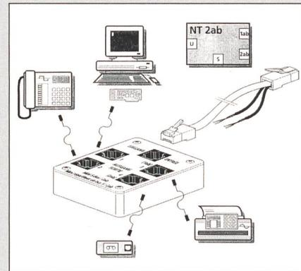
sehr kostengünstig durch den Installateur vorgenommen werden: Der analoge Anschluss muss je nach Situation separat erstellt werden. Die Lösung des Problems wird mit dem Plug-and-Play-Produkt von Furrer Telecommunications GmbH auf elegante Art gelöst. Alle Endgeräte können am Mini S-Bus 2ab eingesteckt werden, welcher seinerseits am NT 2ab angeschlossen wird. Die Lösung eignet sich für die NT-2ab-Versionen von Siemens und Ascom.
