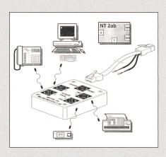
sehr kostengünstig durch den Installateur vorgenommen werden: Der analoge Anschluss muss je nach Situation separat erstellt werden. Die Lösung des Problems wird mit dem Plug-and-Play-Produkt von Furrer Telecommunications GmbH auf elegante Art gelöst. Alle Endgeräte können am Mini S-Bus 2ab eingesteckt werden, welcher seinerseits am NT 2ab angeschlossen wird. Die Lösung eignet sich für die NT-2ab-Versionen von Siemens und Ascom.
