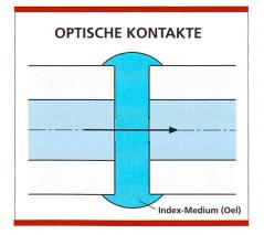
Bild 2. Der plane, rechtwinklige Übergang mit Anpassung des Brechungsindexes.
