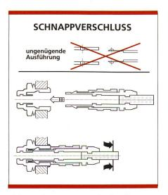
Bild 18c. Schnappverschluss (Push-Pull).
