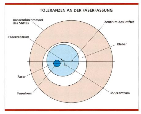
Bild 12. Toleranzen an der Faserfassung.
