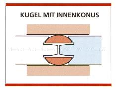
Bild 9. Faserzentriersystem: Kugel mit Innenkonus.
