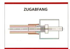
Bild 17a. Zugabfang an der Ferrule.
