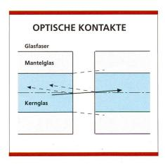
Bild 1. Der plane, rechtwinklige Übergang mit Luftspalt.
