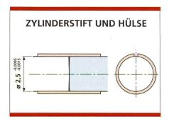
Bild 11. Faserzentriersystem: Zylinderstift und -hülse.
