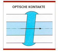
Bild 5. Der plane, schiefwinklige Glaskontakt mit Indexanpassung.
