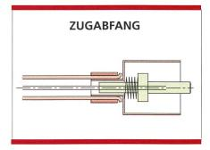
Bild 17b. Zugabfang über den Gehäuseverschluss.
