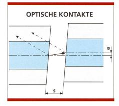
Bild 4. Der plane, schiefwinklige Glaskontakt mit Luftspalt.
