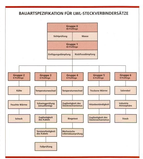
Bild 20. Bauartspezifikation für LWL-Steckverbindersätze. Prüfprogramm für die Prüfung bei fester Stichprobengrösse.
