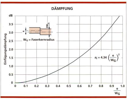
Bild 7. Dämpfung zwischen zwei Einmoden-LWL in Abhängigkeit des normierten Versatzes e/W<sub>G</sub>.
