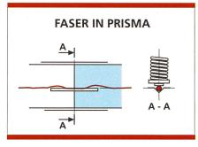
Bild 8. Faserzentriersystem: prismatische Vertiefung für Fasern.
