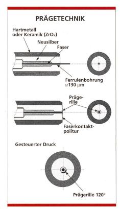
Bild 15. Zentrierung durch Prägetechnik.
