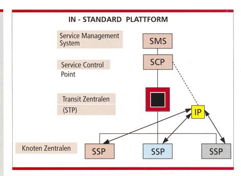
Bild 3. IN-Standardplattform Standart mit SSP-Funktionen voll integriert im Netz.
