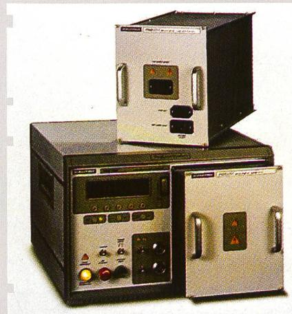
wichtiges Element der meisten nationalen und internationalen EMV-Normen für elektrische und elektronische Produkte für den Einsatz in Büro, Haushalt oder in der Industrie. Das NSG 2050 bietet steckbare Pulsmodule für den Test nach allen gängigen europäischen, US-amerikanischen und IEC-Normen für Industrie-, Haushalts- und Telekommunikationsgeräten. Automatisierte Ein- und Dreiphasen-Koppelnetzwerke sind ebenfalls erhältlich.
