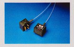
ist mit einem Pigtail für Multimodeoder Singlemode-Anwendungen ausgerüstet. Im Betrieb mit Single-Mode-Fasern lassen sich damit Distanzen bis 15 km überbrücken. Dank dem weiten Temperaturbereich von –40 bis +85 °C eignet sich der 1300-nm-Empfänger für den Einsatz in Telekommunikationseinrichtungen, Datennetzen und digitalen Videosystemen.
