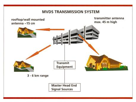
Bild 23. Point-to-Multipoint-Fernsehverteilsysteme.
