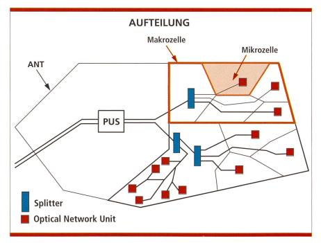
Bild 3. Aufteilung des AN in Mikro- und Makrozellen.
