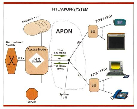
Bild 18. Struktur eines FITL/APON-Systems.
