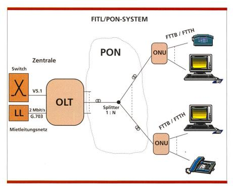
Bild 17. Struktur eines FITL/PON-Systems.
