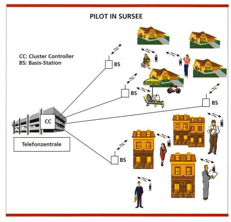
Bild 28. Schematischer Aufbau des DECT-Systems.
