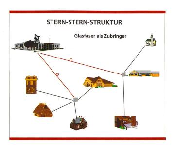
Bild 22. Stern-Stern-Struktur.
