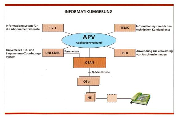
Bild 25. Informatikumgebung im Bereich Anschlussnetz.
