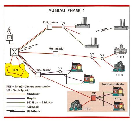
Bild 7. Ausbau des AN in der Phase 1.
