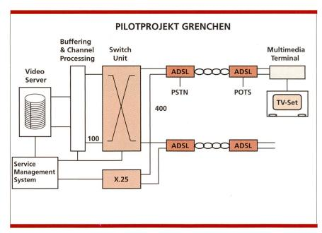
Bild 26. Prinzip des ADSL-Pilotprojekts Grenchen.
