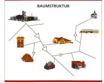
Bild 20. Traditionelle Koaxialbaumstruktur zur Verbreitung von Kabelfernsehprogrammen.
