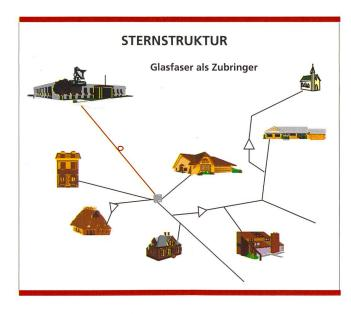
Bild 21. Sternstruktur, Ersatz des Stammkabels durch eine Glasfaserzuleitung.
