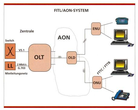
Bild 19. Struktur eines FITL/AON-Systems.
