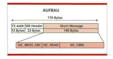
Bild 3. Aufbau einer SICAP SMS.
