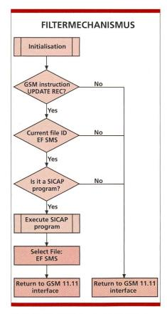
Bild 2. Filtermechanismus auf der SIM Card.
