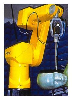
Fig. 1. Robot de mesure avec sonde triaxiale (en haut). Mannequin rempli d'un liquide comparable aux tissus humains et radiotéléphone appliqué à la tête (en bas).
