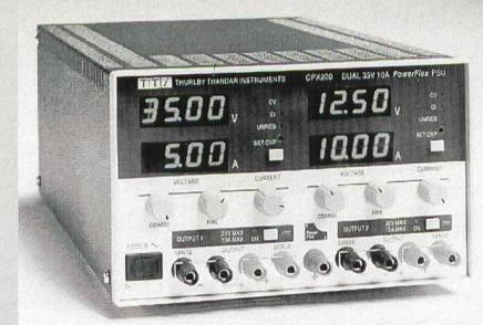
Ausgang separat für Strom und Spannung. Mit der Feineinstellung lassen sich Spannungen auf 10 mV genau einstellen, die logarithmische Regelung für den Strombereich ermöglicht ein feines Abstimmen auch kleiner Stromgrenzen. Beide Ausgänge können einzeln abgeschaltet werden, dabei werden die eingestellten Grenzwerte an den Anzeigen sichtbar. Der variable Überspannungsschutz ist justierbar, und zwar von 10 bis 110 % der maximalen Ausgangsspannung oder 3,5 bis 38,5 V.
