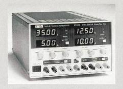
Ausgang separat für Strom und Spannung. Mit der Feineinstellung lassen sich Spannungen auf 10 mV genau einstellen, die logarithmische Regelung für den Strombereich ermöglicht ein feines Abstimmen auch kleiner Stromgrenzen. Beide Ausgänge können einzeln abgeschaltet werden, dabei werden die eingestellten Grenzwerte an den Anzeigen sichtbar. Der variable Überspannungsschutz ist justierbar, und zwar von 10 bis 110 % der maximalen Ausgangsspannung oder 3,5 bis 38,5 V.
