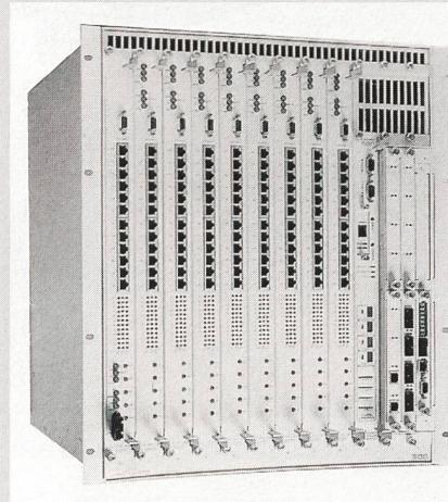
Hubchassis, die auch Remote eingesetzt sein können, auf die Matrix-Backplane zugreifen und so zu einer einzigen Switching-Unit zusammenwachsen und gleichzeitig die volle ATM-Kapazität erhalten bleibt. Die neue Architektur eignet sich ganz besonders für die zentrale Koordination stark strukturierter grosser Netze, eine Infrastruktur, die beispielsweise in den Zentralen mittelständischer und grosser Unternehmen besondere Anforderungen an die aktiven Komponenten stellt.
