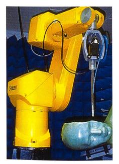
Bild 1. Messroboter mit dreiachsiger Feldsonde (oben). Körpernachbildung gefüllt mit gewebesimulierender Flüssigkeit und anliegendem Mobiltelefon (unten).
