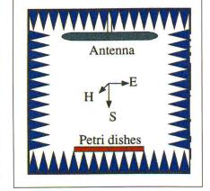
Bild 2. Vertikalschnitt durch die Expositionskammer (mit HF-Absorbermaterial ausgekleidet) für die Experimente an Hefezellen. Die Zellkulturen (unten) werden in sogenannte Petrischalen auf der Oberfläche eines Nährmediums ausgebracht (bis 106 Zellen pro Experiment).
