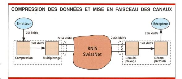
Fig. 1. Augmentation de la capacité de transmission du RNIS grâce à la compression des données et à la mise en faisceau des canaux.
