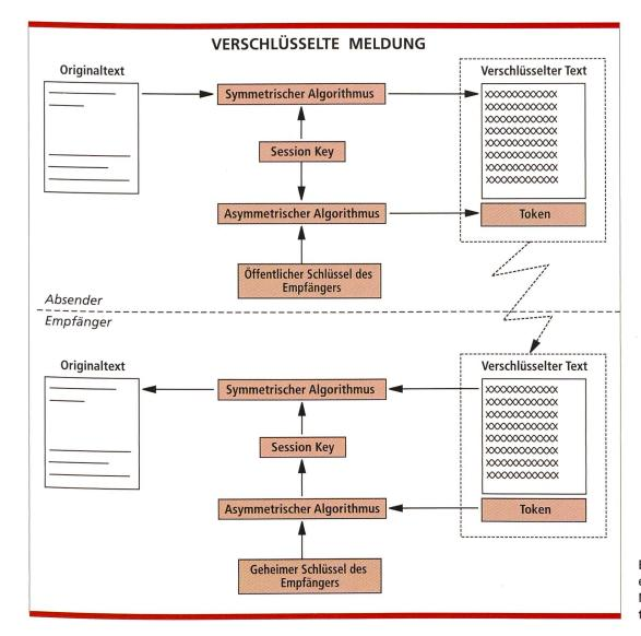
Bild 8. Übermittlung einer verschlüsselten Meldung (ohne Unterschrift).
