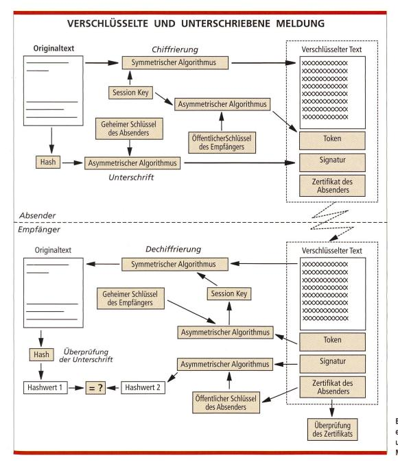
Bild 9. Übermittlung einer verschlüsselten und unterschriebenen Meldung.
