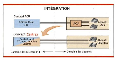
Figure 1. Intégration des fonctions d'un ACU dans le réseau des Télécom PTT.
