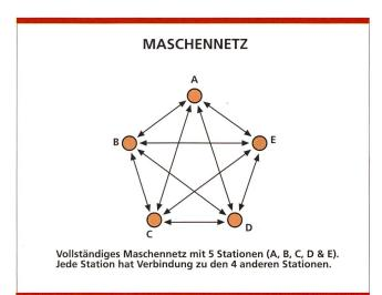
Bild 2a, b, c Beispiel eines vollständigen Maschennetzes mit fünf Bodenstationen mit IDR (FDMA).
