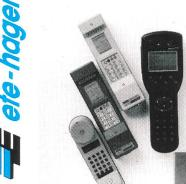
TREND Die aurora Geräteserie dient zur problemlosen Inbetriebnahme und raschen Fehlerlokalisierung der üblichen ISDN Schnittstellen. Die Signalisierung auf dem D-Kanal kann in verschiedenen Protokollen (ETSI, 1TR6, QSIG, u.a.) erfolgen und auf den B-Kanälen können simultan Daten und Gespräche verschiedener Dienste geschaltet werden, aurora Testgeräte erlauben die Emulation der ISDN-Komponenten TE und NT.
