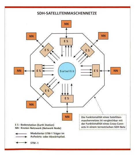
Bild 6. Beispiel eines SDH-Satellitenmaschennetzes mit sieben Bodenstationen.
