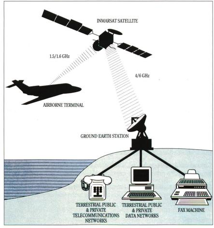
Bild 2. Das INMARSAT-Aero-System.
