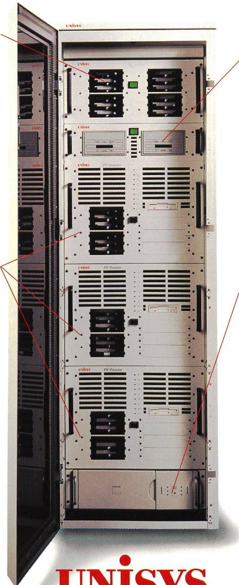
Das DAT-Stacker-Schubfach weist eine Kapazität bis 192 GB auf. Das befreit Sie ein für allemal von allen Back-up-Sorgen. Der vollautomatische Back-up wird durch zwei separate Autoloader gemanagt, die je mit bis zu zwölf Tapes bestückt sind, ohne menschliches Zutun, wohl verstanden.
