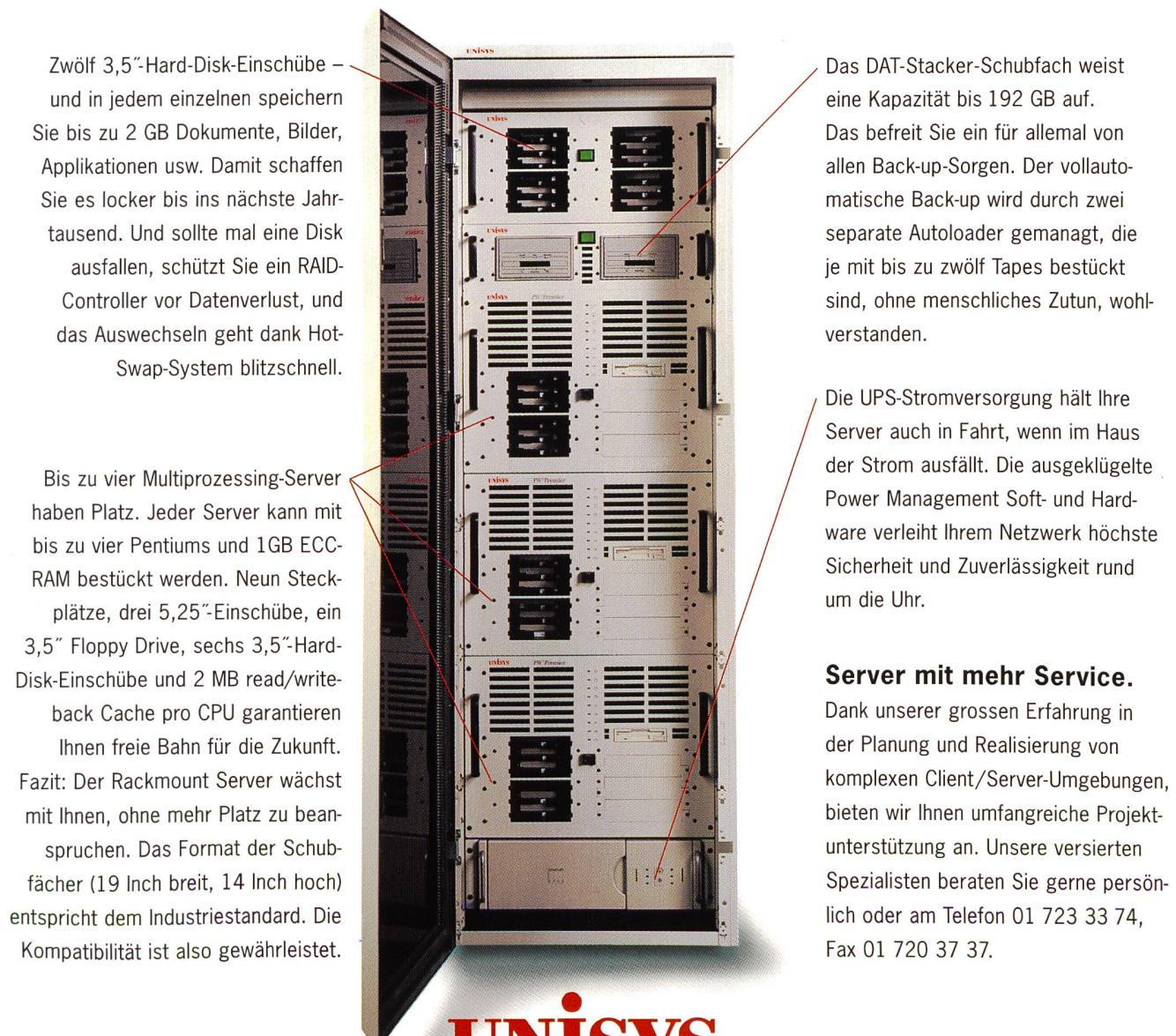
Zwölf 3,5"-Hard-Disk-Einschübe – und in jedem einzelnen speichern Sie bis zu 2 GB Dokumente, Bilder, Applikationen usw. Damit schaffen Sie es locker bis ins nächste Jahrtausend. Und sollte mal eine Disk ausfallen, schützt Sie ein RAID-Controller vor Datenverlust, und das Auswechseln geht dank Hot-Swap-System blitzschnell.
