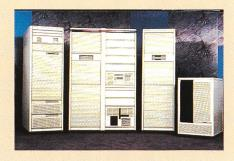
Die SMP-(symmetrisches Multiprocessing-)Server können mit zwei bis zehn Intel-Pentium- oder Pentium-Pro-Prozessoren bestückt werden. Diese Server werden innerhalb der neuen ClearPath-Familie unter der Bezeichnung SMP61000 vertrieben. Sie verfügen über höchste Verfügbarkeit und RISC-Leistung, kombiniert mit den wirtschaftlichen Vorteilen der in grossen Mengen produzierten Intel-Prozessoren. Die SMP6100G Server sind für den Server-Markt im mittleren und oberen Bereich vorge-
