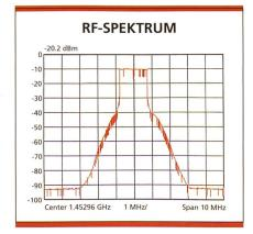
Bild 4. RF-Spektrum eines DAB-Senders.
