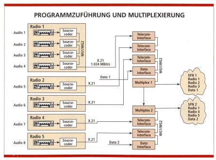
Bild 16. Blockschema der Programmzuführung und Multiplexierung.
