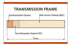
Bild 3. Struktur des DAB-Transmission-Frame.
