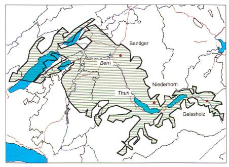
Bild 10. Berechnetes versorgtes Gebiet, Frequenzblock 12B.
