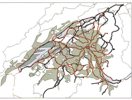
Bild 19. Vergleich zwischen Berechnung und Messung für den Sender Bantiger.
