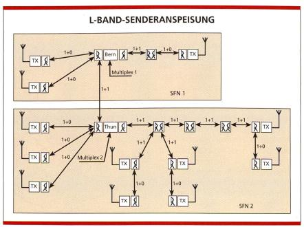
Bild 17. Blockschema der L-Band-Senderanspeisung.
