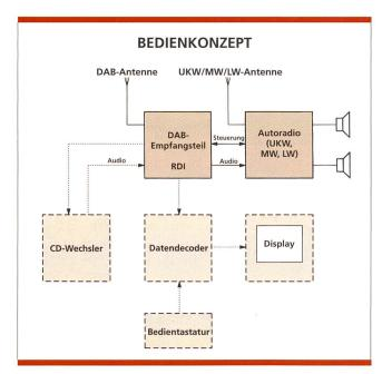
Bild 7. Bedienkonzept der DAB-Pilotempfänger.
