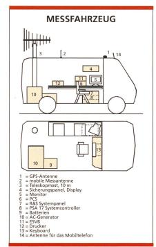
Bild 18. Layout des Messfahrzeugs.
