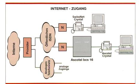
Bild 9. Internet-Zugang mit dem Apparat Ascotel Crystal.
