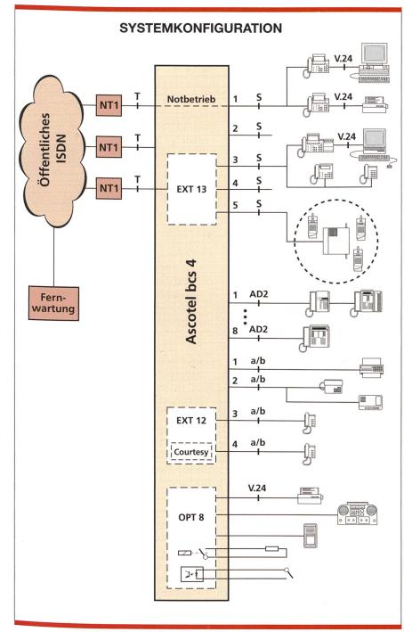
Bild 1. Systemkonfiguration der TVA Ascotel bcs 16. Es sind nicht alle möglichen Erweiterungskarten eingezeichnet.
