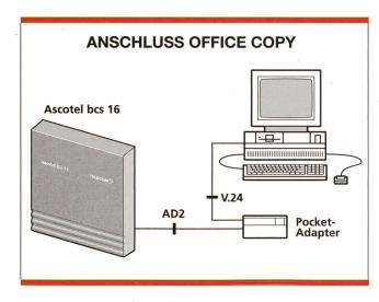
Bild 4. So wird Office Copy angeschlossen.
