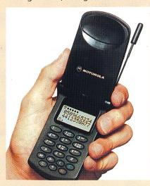
Minuten Gesprächszeit oder 12 Stunden Betriebsbereitschaft. Ist die Energie der ersten Batterie aufgebraucht, übenimmt automatisch die zweite Batterie die Energiezufuhr. Der Benützer kann also nuhig weitertelefonieren, während er die leere Batterie austauscht.
