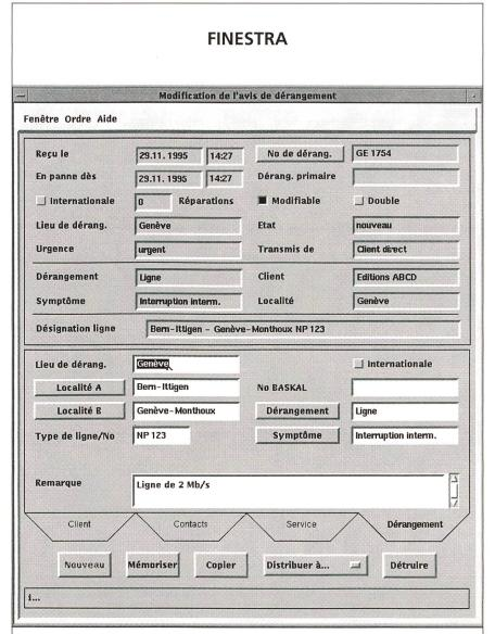
Fig. 4. La finestra di rilevamento di un avviso di guasto: la finestra «Nouvel avis de dérangement» propone quattro registri: «Client», «Contact», «Service», «Dérangement» per il rilevamento di dati specifici.
