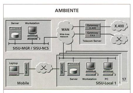
Fig. 1. L'ambiente SISU: Telecom PTT impiega il sistema SISU per la gestione integrata degli avvisi di guasto e di riparazione, nell'ambiente multi-venditore e multi-tecnologico del servizio di trasmissione.
