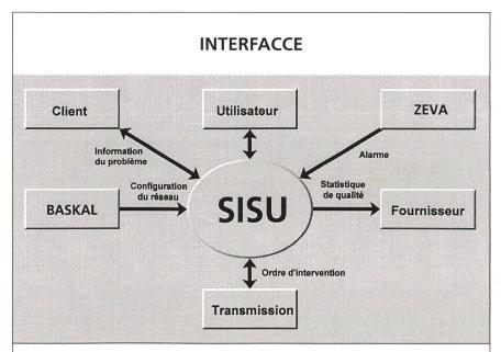
Fig. 2. Le interfacce fra il sistema SISU e i sistemi esterni: uno standard industriale di base di dati relazionali e un sistema di comunicazione che permettono al sistema SISU di scambiare dati e informazioni con altri sistemi di controllo e di gestione.
