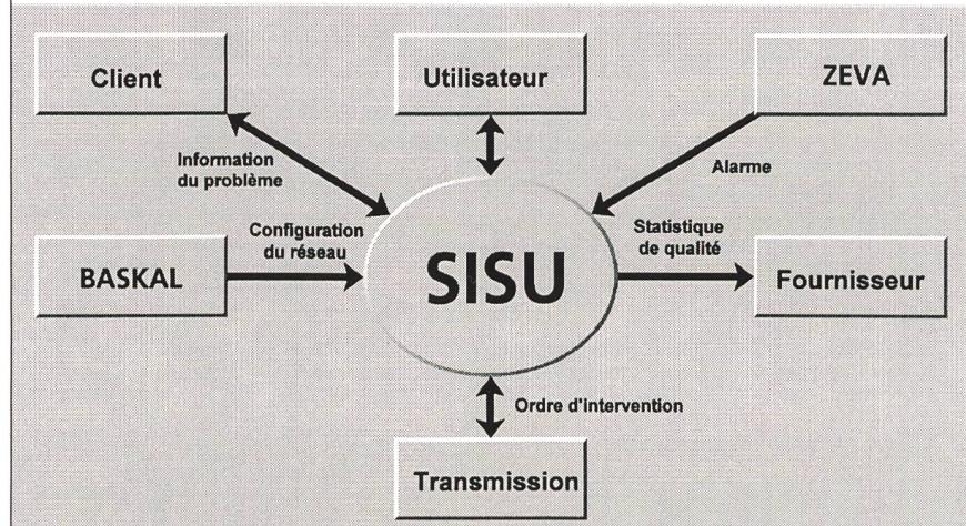
Fig. 2. Le interfacce fra il sistema SISU e i sistemi esterni: uno standard industriale di base di dati relazionali e un sistema di comunicazione che permettono al sistema SISU di scambiare dati e informazioni con altri sistemi di controllo e di gestione.
