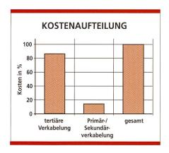
Bild 3. Kostenaufteilung einer Kommunikationsverkabelung.
