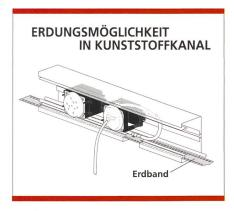
Bild 22. Erdungsmöglichkeit bei Anschlussdosen in Kunststoffkanälen.
