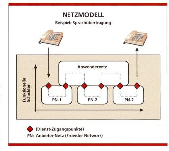
Bild 24. Ansatz des Netzmodells am Beispiel einer Telefonverbindung.
