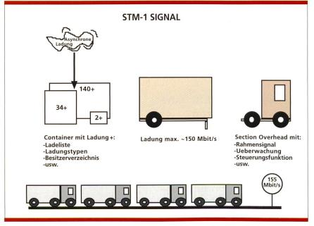
Bild 5. Das STM-I-Signal als Lastwagen für den Transport von verschiedenen Containern.
