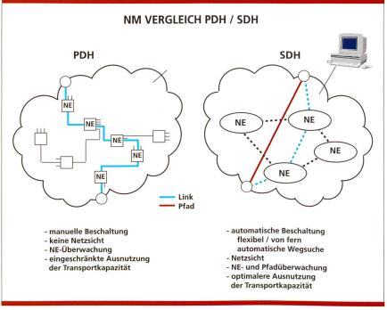
Bild 3. Gegenüberstellung der Pfadbereitstellung in PDH/SDH-Technologie.
