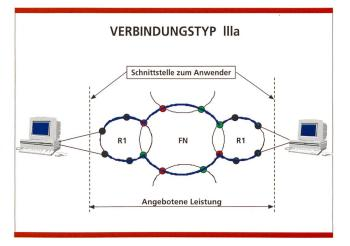
Bild 16. Typ Illa: Verbindung mit zwei unabhängigen Anschlüssen. Der Übergang vom Anschlüssnetz zum Basisnetz erfolgt nach dem «Dual-homing»-Prinzip. Dieser Typ wird nur ab der Regionalebene 1 angeboten.
