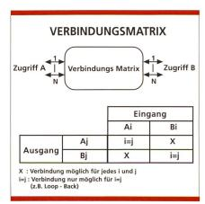
Bild 7. Beispiel einer Verbindungsmatrix mit zwei Zugriff-Ports.
