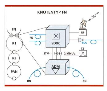
Bild 9. SDH-Netzknoten vom Typ FN (Fernnetzknoten).
