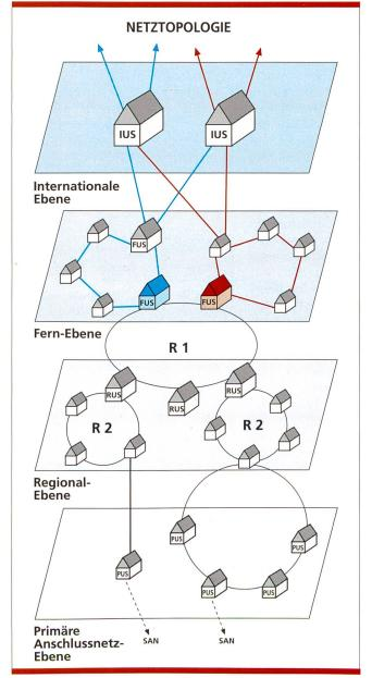
Bild 8. Topologie des Transportnetzes *SYDINET*®.
