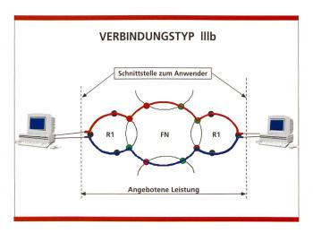
Bild 17. Typ IIIb: Verbindung mit zwei unabhängigen Anschlüssen. Der Übergang vom Anschlüssnetz zum Basisnetz erfolgt nach dem «Dual-routing»-Prinzip. Dieser Typ wird nur ab der Regionalebene 1 angeboten.
