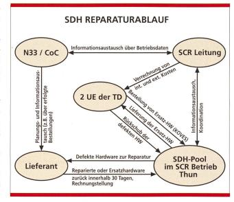
Bild 21. Die Abläufe für die Reparaturen und das Reservematerial.
