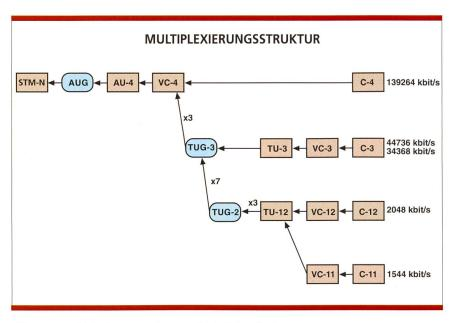
Bild 4. SDH-Multiplexierungsstruktur gemäss ETSI-Standard.
