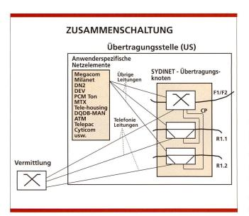
Bild 13. Verbindungen zwischen den Vermittlungseinheiten und den anwendungsspezifischen Netzelementen zum SDH-Netzknoten in einer Übertragungsstelle.
