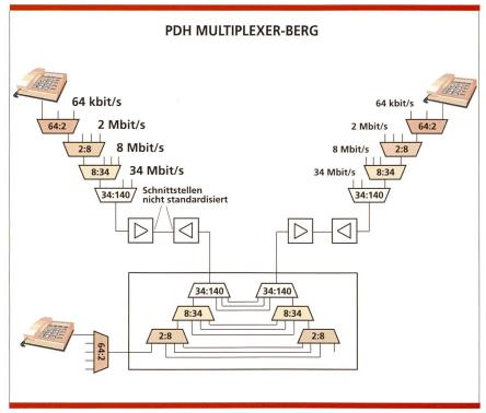
Bild 2. Gegenüberstellung PDH-Multiplexer-Berg/SDH-Lösung.
