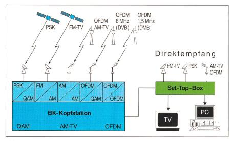
Bild 2. Fernsehübertragungsverfahren, welche zur Diskussion stehen.
