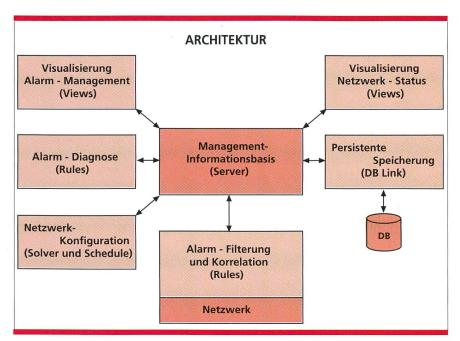
Bild 4. Architektur des Netzwerkmanagementsystems mit diversen Komponenten.
