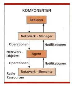
Bild 1. Komponenten eines Netzwerkmanagementsystems.
