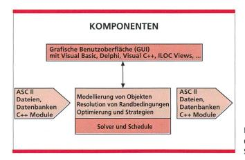
Bild 3. Architektur der Komponenten Solver und Schedule.
