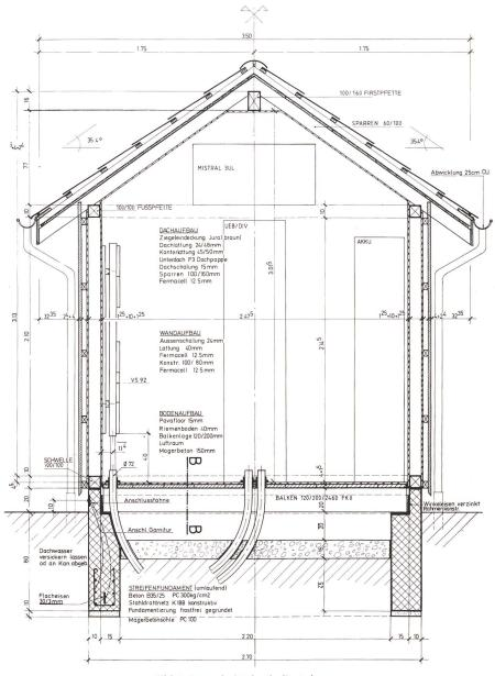
Bild 3. Querschnitt durch die Anlage.
