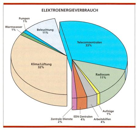
Bild 7. Elektroenergieverbrauch nach Verwendungszweck.
