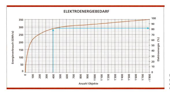
Bild 6. Elektroenergiebedarf 1994 Telecom PTT nach Anzahl Gebäuden.
