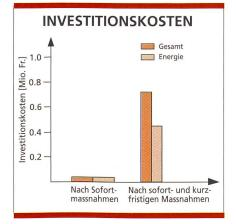
Bild 4. Gesamtinvestitionskosten (Gitterflächen) und energiebedingte Investitionskosten (schraffierte Flächen) für die Sofort- oder die Sofort- und kurzfristigen Sanierungsmassnahmen beim untersuchten PTT-Gebäude am Zentweg 9 in Bern.
