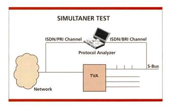
Bild 5. Simultaner ISDN-Test auf Primärratenund Basisratenanschluss.
