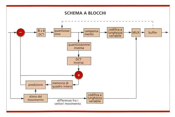
Figura 5. Schema a blocchi di un codificatore video.
