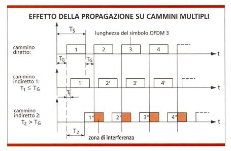
Figura 12. Effetto della propagazione su cammini multipli.
