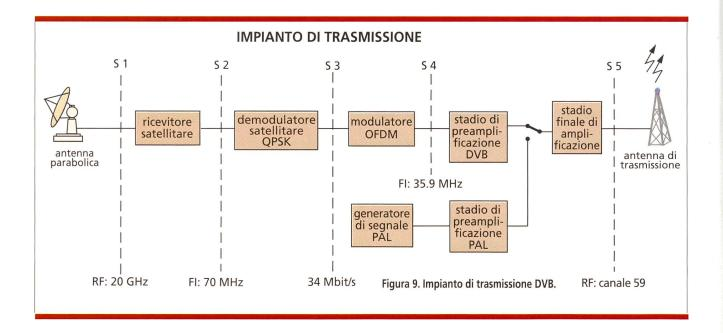
ne effettuata la decompressione, cosicché all'interfaccia S5 è presente, per ogni canale, un segnale con un bit rate di 216 Mbit/s. Affinché sia possibile rappresentare le immagini sui monitor con il nuovo formato 16 : 9, i segnali subiscono una conversione digitale/analogica e sono poi inviati agli ingressi RGB di comuni apparecchi televisivi.
