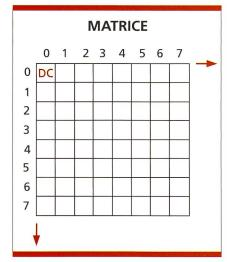
Figura 1. Matrice 8×8 dei coefficienti DCT (strutture di pixel variabili lentamente: angolo in alto a sinistra; strutture di pixel variabili velocemente in senso orizzontale: a destra; strutture di pixel variabili velocemente in senso verticale: a sinistra).
