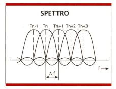
Figura 6. Spettro nel caso del procedimento ODFM.
