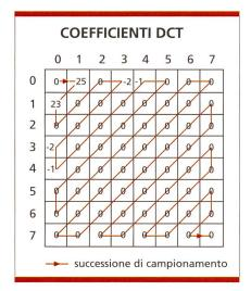
Figura 3. Matrice dei coefficienti DCT quantizzati.
