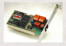
auch mit der passiven Hardware der SWOX-CARD eine hohe Performance mit zwei B-Kanälen erreichen. Der So 2.0 ist für den direkten Einbau in den PC vorgesehen und benötigt zum Anschluss an das Swissnet-Netz lediglich das beigefügte Kabel.
