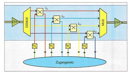
Bild 6. Optischer 4-Kanal-Add/Drop-Multiplexer.
