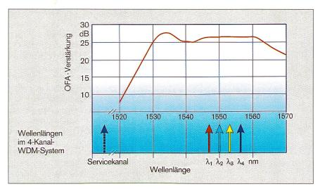
Bild 4. Wellenlängenmultiplex und optischer Fasenverstärker (OFA).
