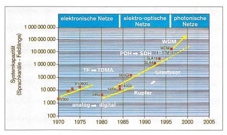
Bild 7. Entwicklung der Übertragungssysteme.
