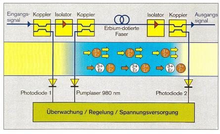
Bild 2. Prinzip des Erbium-dotierten optischen Faserverstärkers.
