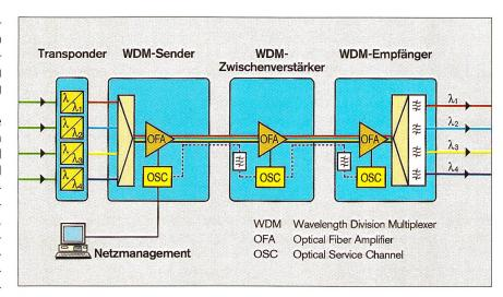
Bild 3. Wellenlängen-Multiplexsystem mit vier Kanälen.
