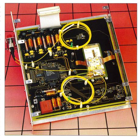
Bild 8. Der optische Transponder ist auf einer Doppeleuropakarte untergebracht. Sie enthält Empfängerdiode, Verstärker, Lasersender sowie Funktionen zur Überwachung und Steuerung. (Alle Bilder: Bosch)
