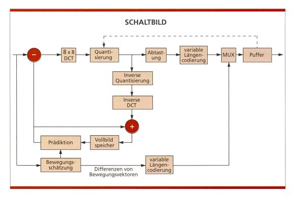
Bild 5. Prinzipschaltbild eines Videocoders.
