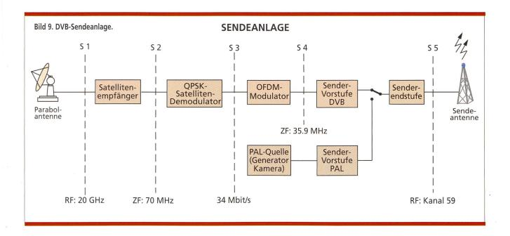
Schnittstelle S5 pro Kanal ein Signal mit der Datenrate von 216 Mbit/s ansteht. Damit die Bilder auf den Monitoren mit dem neuen Bildseitenverhältnis von 16:9 dargestellt werden können, werden die Signale digital/analog gewandelt und den RGB-Eingängen der handelsüblichen Fernsehempfänger zugeführt.
