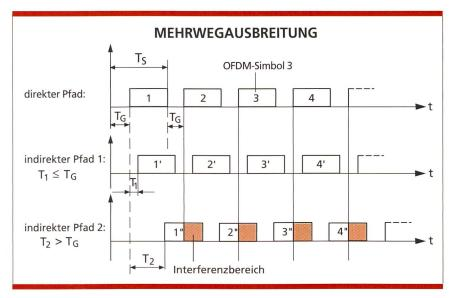
Bild 12. Einfluss der Mehrwegeausbreitung.
