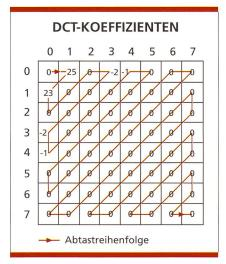
Bild 3. Matrix der quantisierten DCT-Koeffizienten.
