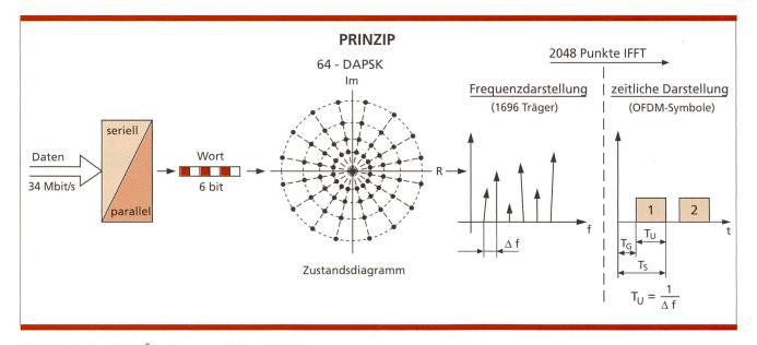
Bild 7. Prinzip des OFDM-Übertragungsverfahrens (2k-FFT).
