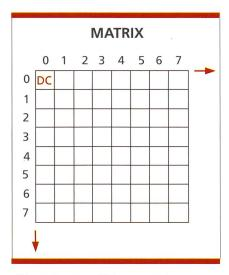
Bild 1. 8×8-DCT-Koeffizienten-Matrix. Langsam veränderliche Pixelstrukturen: linke obere Ecke. Schnell veränderliche horizontale Pixelstrukturen: rechts. Schnell veränderliche vertikale Pixelstrukturen: unten.
