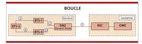
Fig. 3. Boucle de BTS.
