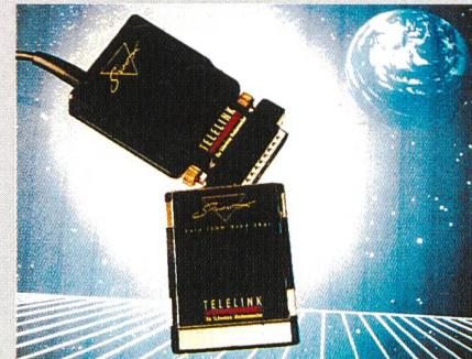
Schnittstelle zum Anschluss an den PC, Übertragungsrate 2x64 kbit/s (B-Kanal) und 1x16 kbit/s (D-Kanal), Softwareschnittstelle COMMOM ISDN, API-Version 1.1, Profil A, Softwareunterstützung ab MS-DOS 3.0, Masse (LxBxH) 93x56x19 mm
